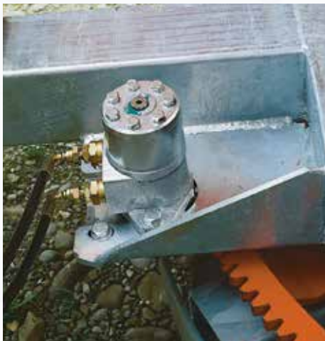
Hydraulikrotation der Scheibe (serienmäßig für alle Modelle mit Ausnahme von 600 Xj, 700 Xj, 600 Xjm).
