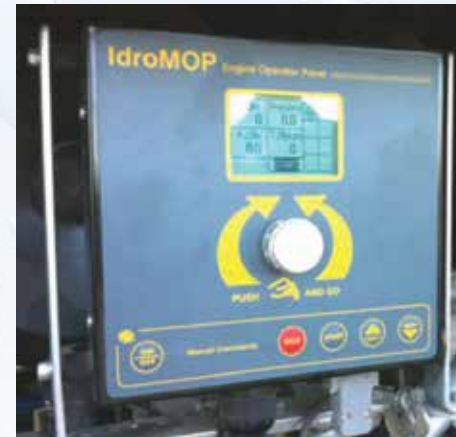
Programmiergerät IDROMOP für gemeinschaftliche Verwaltung von Beregnungsmaschine + Dieselmotor für die Modelle XJM.
