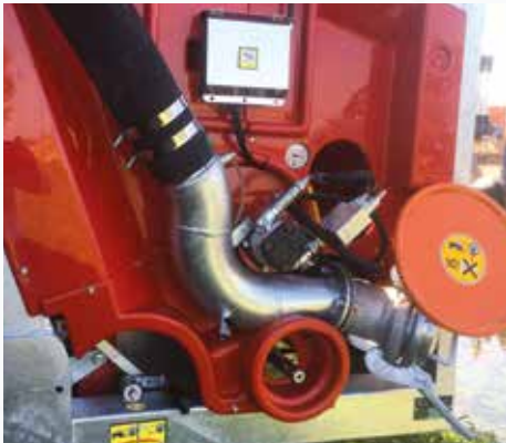
Schlauchaufwicklung mit Dieselmotor YANMAR LD70, komplett mit hydrostatischem Antrieb mit Hydraulikmotor an der Untersetzung, Geschwindigkeitsausgleichsventil, doppelte Hydraulikpumpe für Speisung der Funktionen; mit den elektronischen Programmiergeräten RM kombinierbar. Das Zubehörteil ersetzt die Turbinenaufwicklung.
