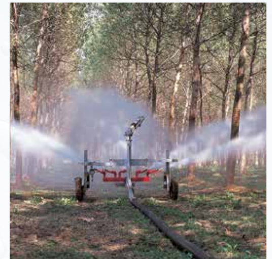
Vorrichtung für Bewässerung unter Baumkronen von hochstämmigen Bäumen.
