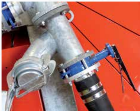
Zusatzanschluss für Jaucheeintritt und Ausschluss der Turbine.
