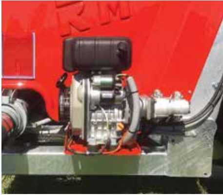
Vom Viertaktmotor HONDA GX160 bzw. Briggs & Stratton Hp 5,5 für Öldruckbetrieb angetriebenes Steuergerät.
