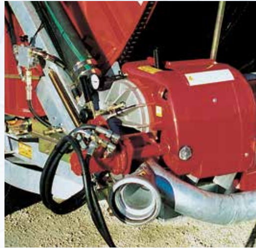
Aufwicklung des PE-Schlauches mittels Hydraulikmotor auf PTO, Geschwindigkeitsregler, Anschlagsverteiler und Schnellanschlusspaar an Traktor
