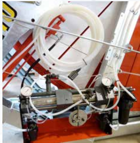
Dosierpumpe für düngende Bewässerung mit Jauche.
