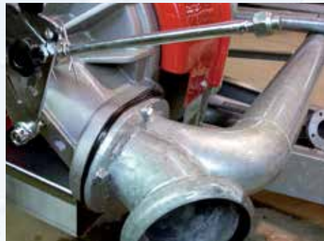
Klarlackierung zum besseren Schutz der verzinkten Teile.
