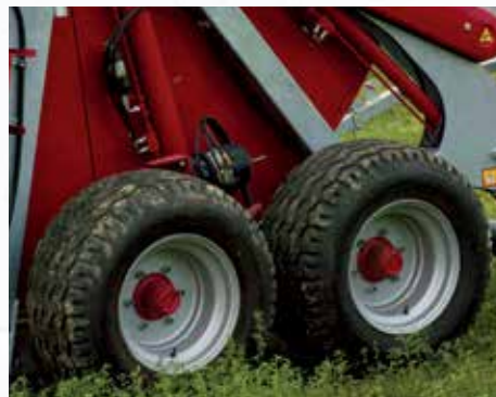
Doppelradachse auf asymmetrischen Ausgleich (Zubehör für Mod. 800 Xj, 840 Xj, 900 Evo, 800 XJM).
