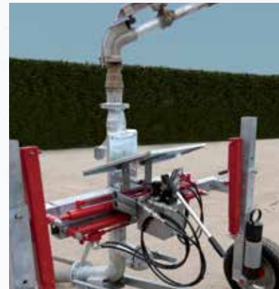
Hydraulikregulierung für Wagenbreite und mechanische Höheneinstellung der Räder.
