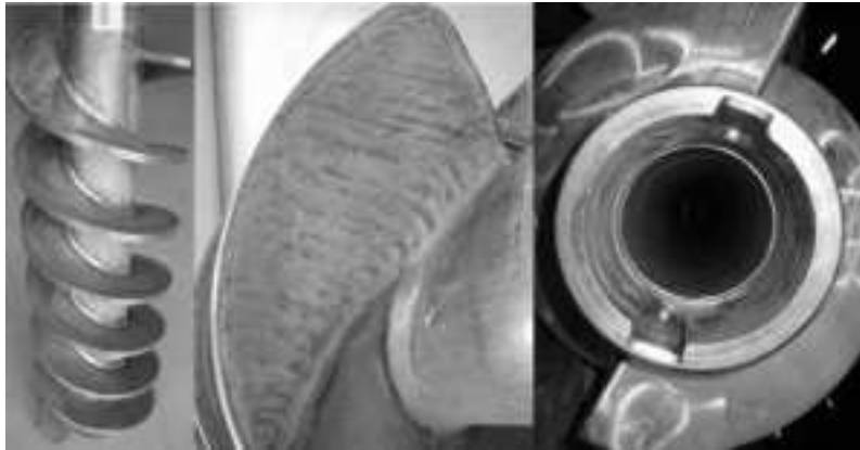
Abb.13-14: Schnecke mit gepanzertem Spezialwerkstoff und Nabenaufnahme, Neuzustand
