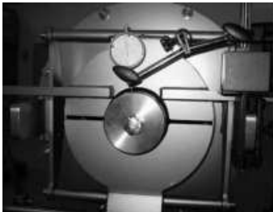
Abb. 13-15: Kontrolle des Taumelschlags der Schnecke
